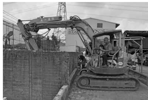
家裡做挖土機生意的林金國，在環保站放了一部挖土機。放置回收物的窟仔滿了，便動用挖土機壓碎，或搬移上環保車，可以節省許多人力。
